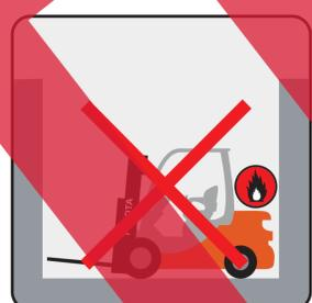
N'utilisez jamais un chariot à gaz dans un espace confiné et fermez le robinet à gaz du chariot lorsqu'il n'est pas utilisé.
